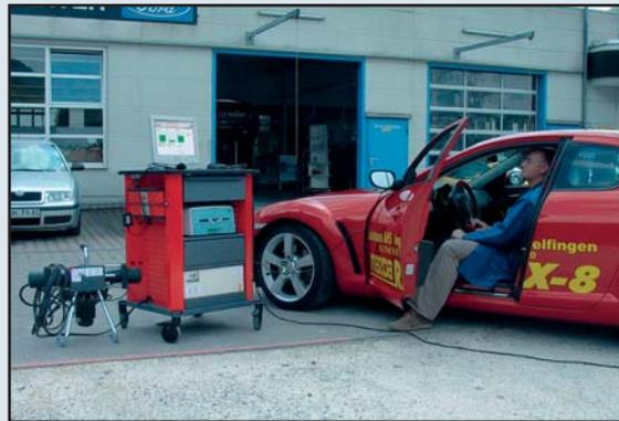
solda: Egzost ölçüm sondasının yerleştirilmesi
